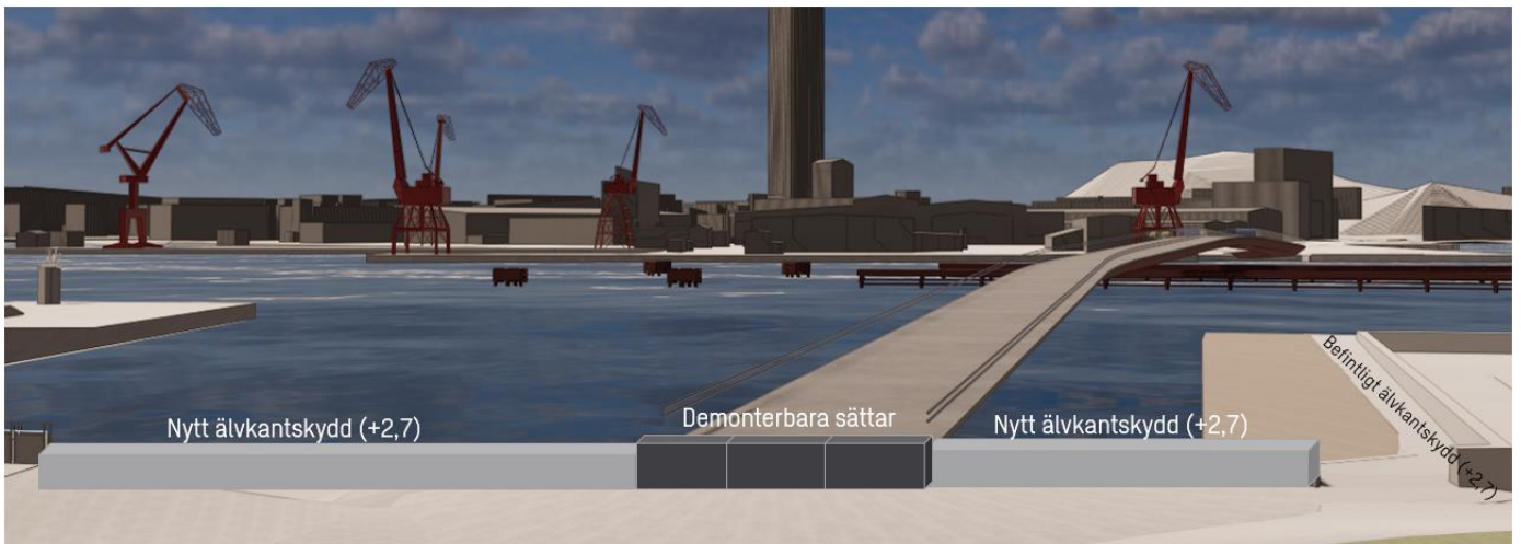
Figur 13. Principiell skiss som visar hur gång- och cykelbrons öppning vid högvattenhändelser kan stängas av manuellt.
